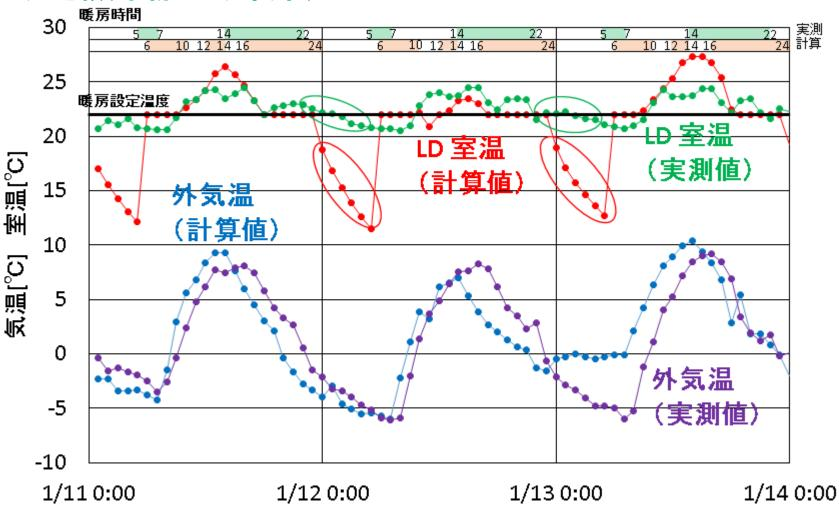
結果:暖房OFF時の室温の低下は、CLT建物(実測:緑枠)は、在来木造
